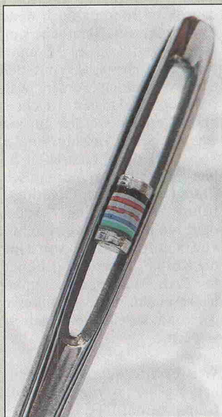
Geht zwar nicht durch ein Nadelöhr, paßt aber in eine Multi-Layer-Schaltung: Micro-Melf-Widerstand!
